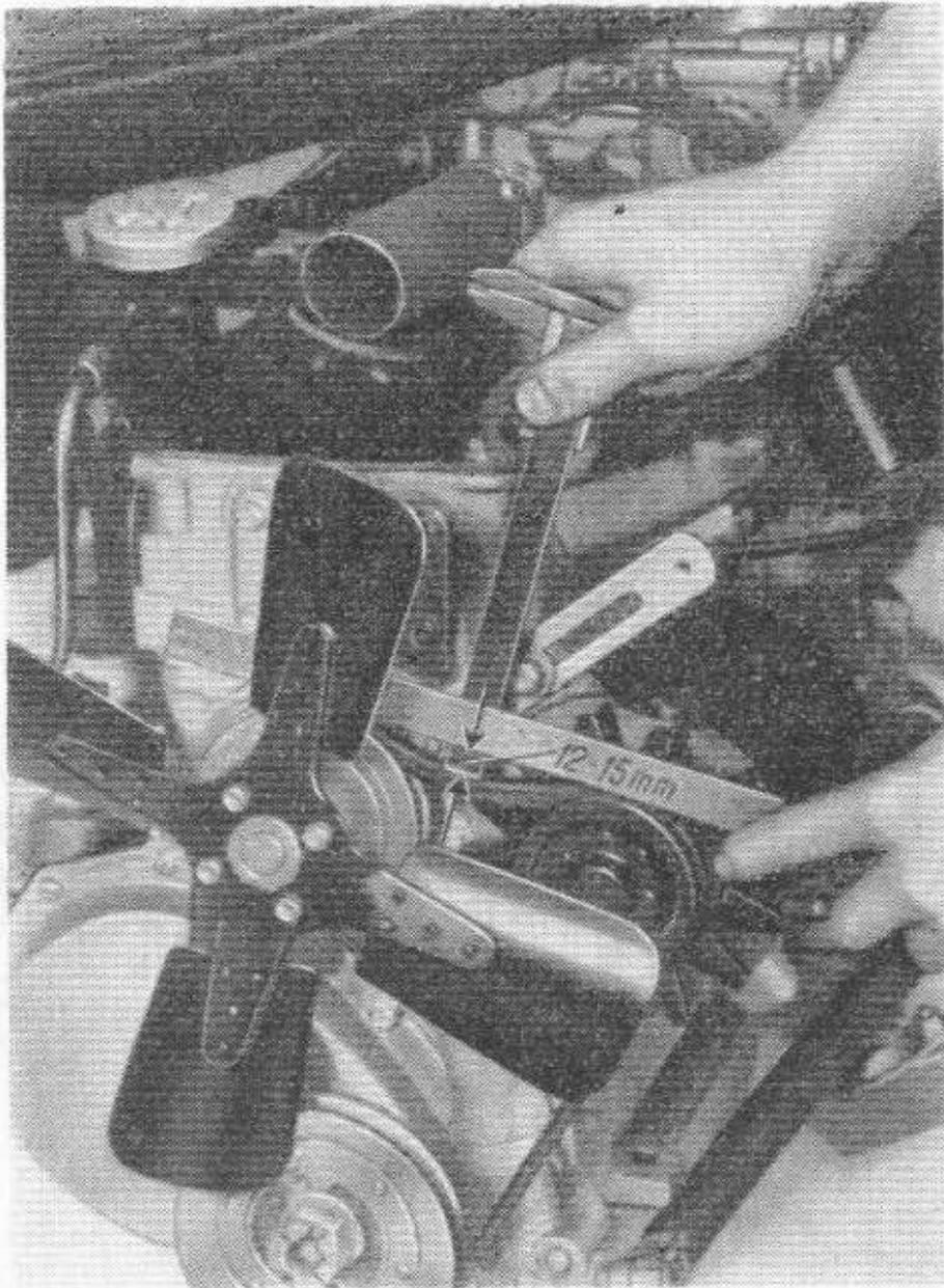
Bild 31. Prüfung der Lüfterriemenspannung
