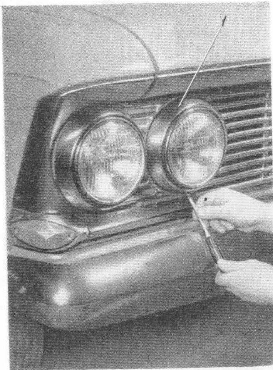
Bild 62. Abbau des dekorativen Frontrings eines Scheinwerfers mit geschlossenem optischem Einsatz (Sealed Beam):
