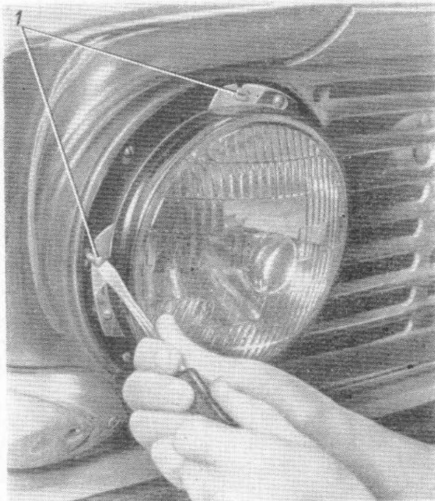
Bild 58. Einstellung der Lage der optischen Einheit im Scheinwerfergehäuse:
