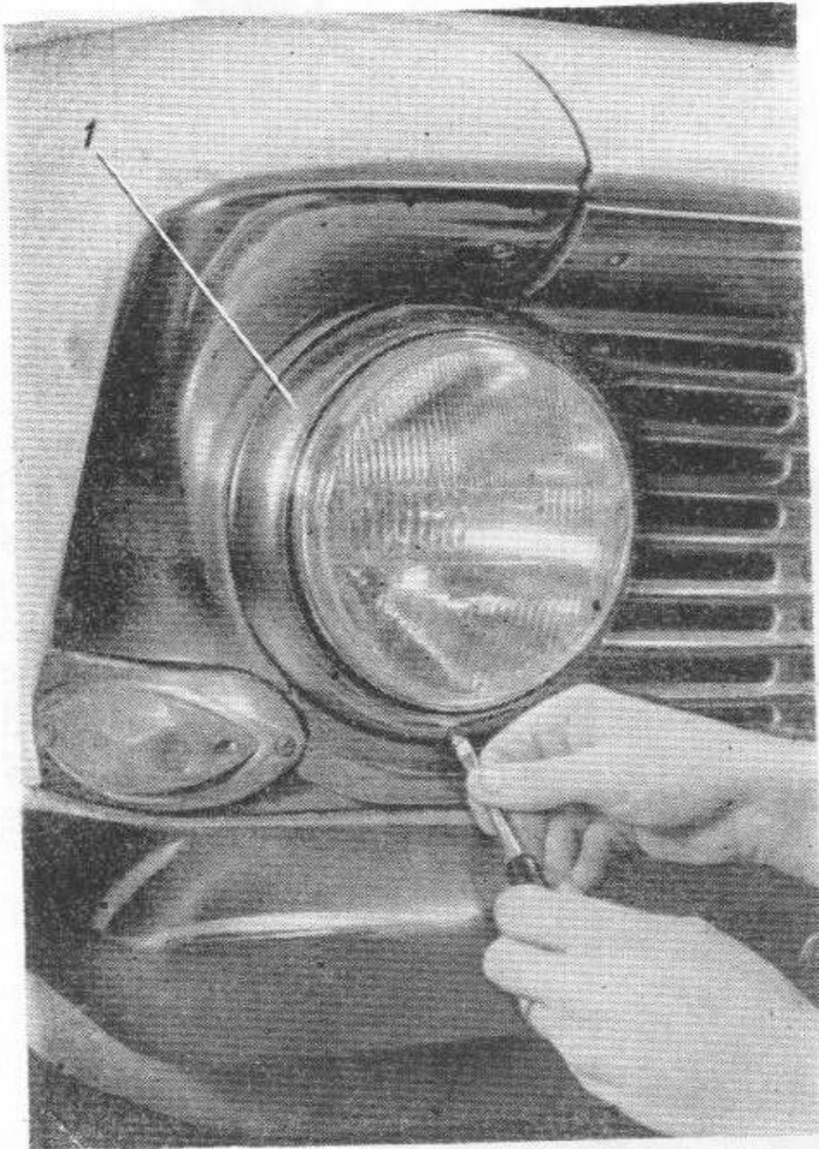
Bild 60. Abbau des dekorativen Frontrings beim Scheinwerfer vom Typ  $\Phi\Gamma 122$ -E:
