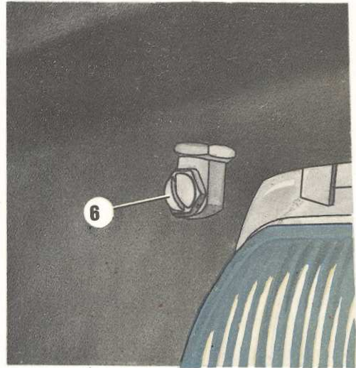
I. РАСПОЛОЖЕНИЕ ЖИКЛЕРА ОМЫВАТЕЛЯ РАССЕЙВАТЕЛЕЙ СВЕТА ФАР
